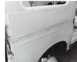
塗装前のグラインダーを掛けたボディ(写真上)および足回りのサビ取り作業の様子(写真右)
