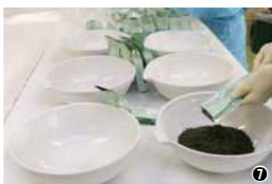
⑦この日は、輸出用のお茶の葉の放射能分析の前処理の手順も見せていただいた。福島第1原発の事故後、輸出品においても安全性の証明は重要になっているという。⑧照射施設の隣の建物「試料前処理棟」にある電気炉・乾燥機室で、450℃の熱を丸1日加えお茶の葉を完全に灰化させる。このお茶の葉の分析に関しては、このあと千葉県の本分析センター本部にて送られ細かな分析を行う予定ということだった。
