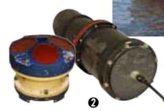
①六ヶ所村再処理工場沖合約3kmに設置される係留式ブイ。海水の流速流向、水温、塩分などの観測データが大湊の研究所に送られてくる。②左が流向流速計で、右が水中放射線センサー。係留式ブイの下に装着される。③こちらが送られてきたデータを観られるシステム。このデータを用いてシミュレーションモデルを作っていく。④シミュレーションモデルの画像。六ヶ所村周辺海域の海の動きがわかる。
