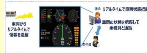
車両の状態監視（JR西日本HPより）
