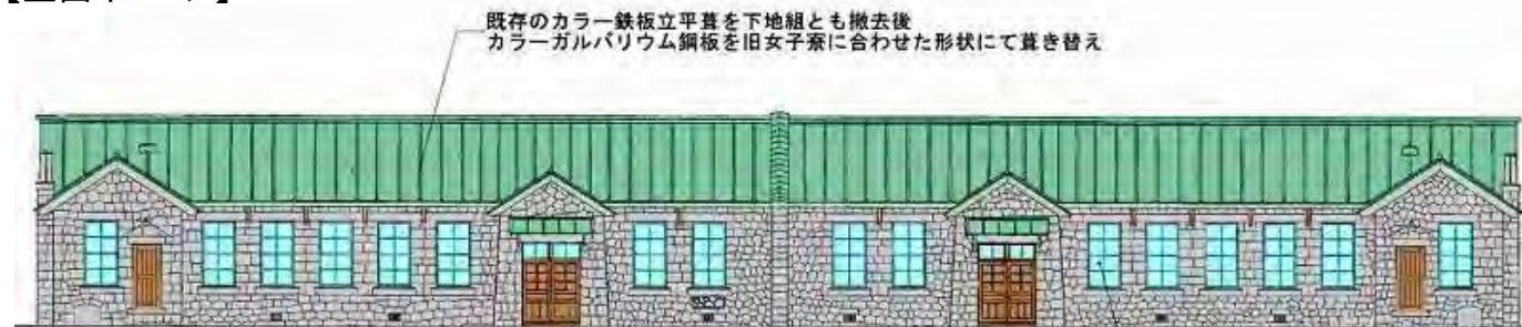
開口閉鎖部分を撤去後 木製建具にて復旧
